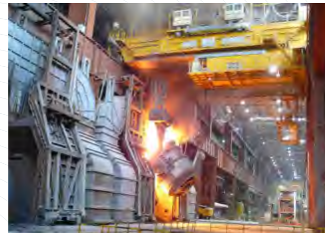
480t铸造起重机 480t Teeming Crane
